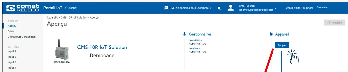
Coupler l'appareil, c'est-à-dire le connecter au portail IoT et lui appliquer la configuration. Assurez-vous que l'appareil est sous tension. Appuyez ensuite sur le bouton «*Pair*» sur l'appareil. Le couplage démarre le «*profil de service*» et donc la facturation.
